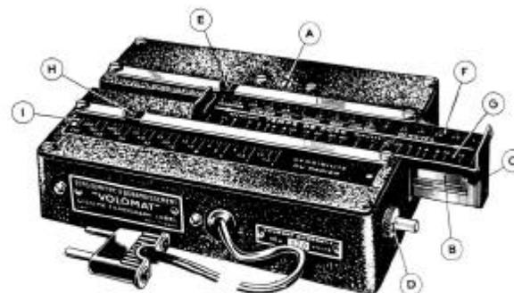
Poser le densitomètre sur le plateau de l'agrandisseur et allumer la lampe à l'aide de l'interrupteur D;
